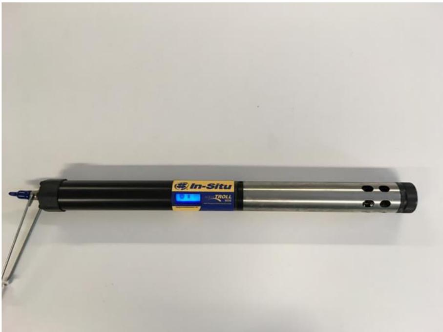
Abbildung 13: Aqua TROLL 600 Multiparameter Sonde
