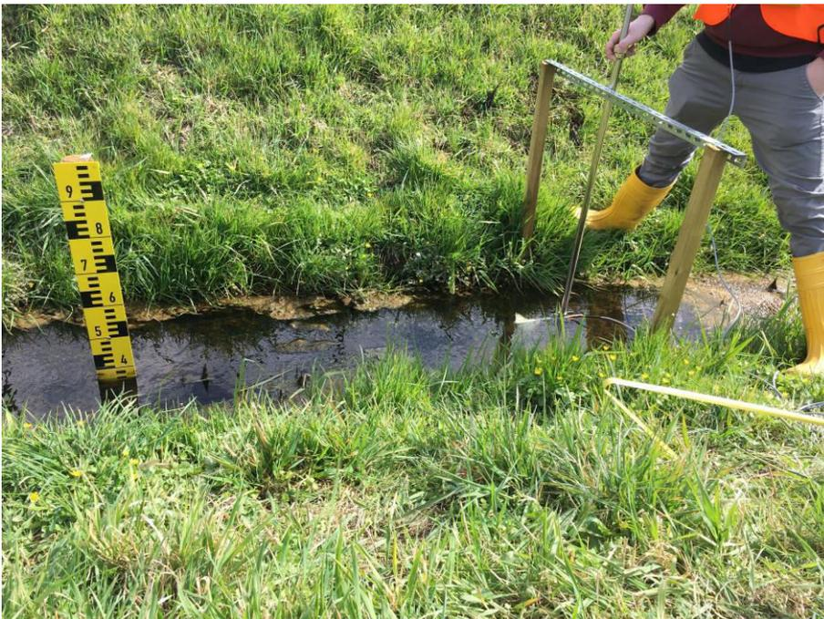
Abbildung 12: Lattenpegel an Messstelle OWM-3.1
