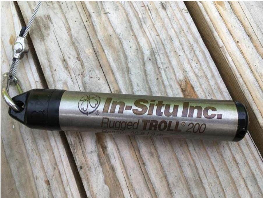
Abbildung 16: Drucksonde Rugged TROLL 200 der Firma In-Situ Inc.
