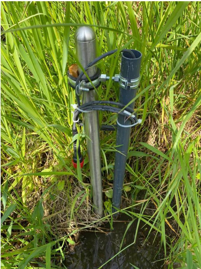
Abbildung 15: Druck-Messstelle
