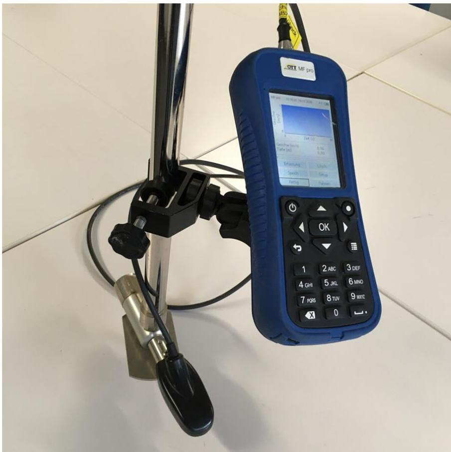
Abbildung 10: Aufbau eines magnetisch-induktiven Strömungsmesser (OTT MF pro)
