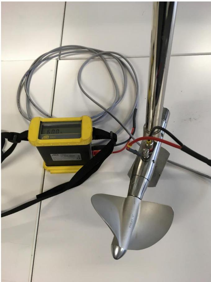
Abbildung 9: Aufbau des Messflügels (OTT C31 und Z400)
