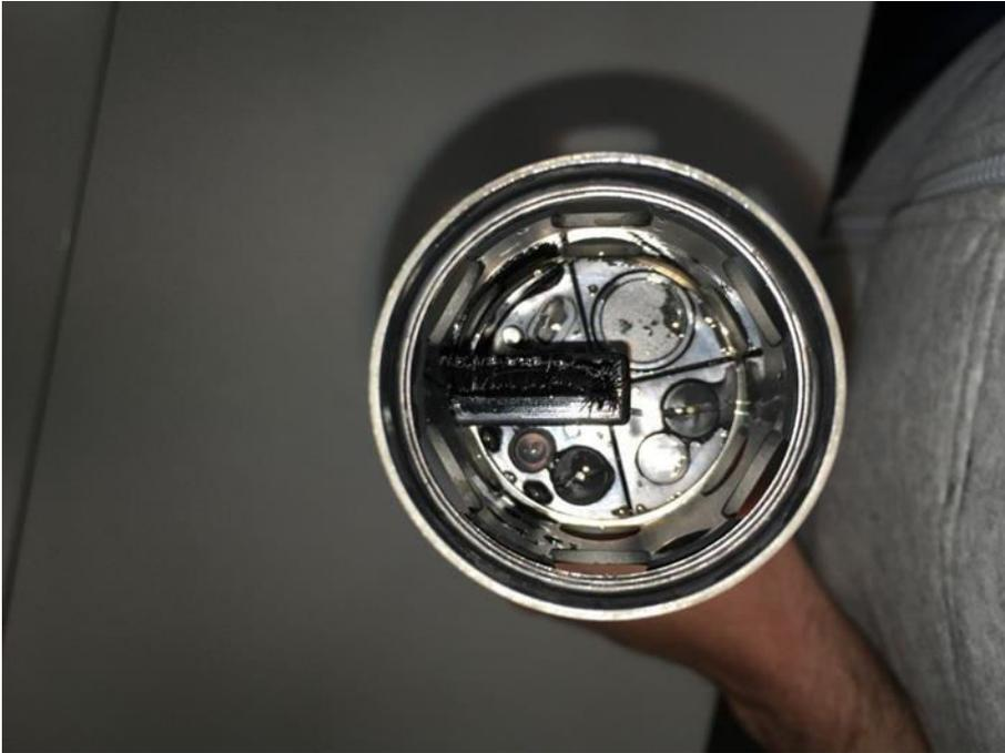
Abbildung 14: Sensoren der Multiparameter Sonde
